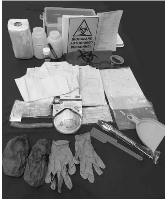
รูปที่ 8.1 ตัวอย่างอุปกรณ์และสารเคมีในชุดจัดการเหตุรั่วไหลทางชีวภาพ (biological spill kit)
