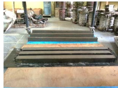
ภาพที่ 2 แบบหล่อและตัวอย่างไม้เทียม
