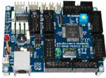
ภาพที่ 4 ชุดไมโครคอนโทรลเลอร์ของบอร์ด ET-BASE PIC8722
