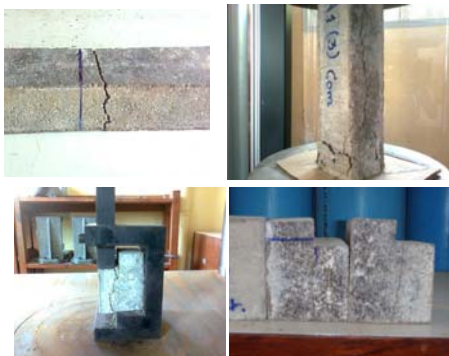
ภาพที่ 5 ลักษณะการวิบัติของตัวอย่างไม้เทียม
