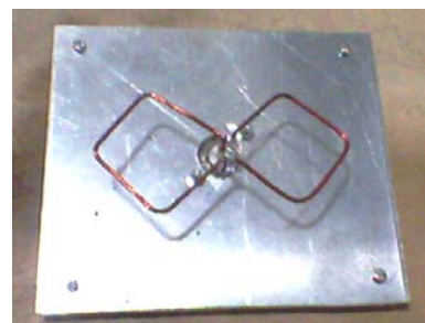
ภาพที่ 1 สายอากาศไบควอดที่ใช้แพร่กระจายคลื่น
