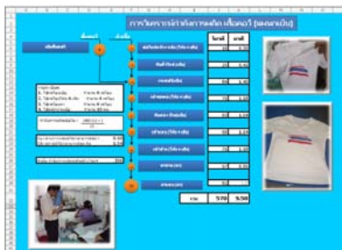
ภาพที่ 5 โปรแกรมวิเคราะห์การผลิตและระบบควบคุม ส่วนของการวิเคราะห์กำลังการผลิตกระบวนการเย็บ โดยใช้ OPC (Outline Process Chart)
