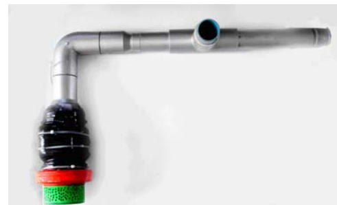
ภาพที่ 7 ชุดเครื่องอัดอากาศและแอร์เจ็ทปั๊มที่ได้ออกแบบ
