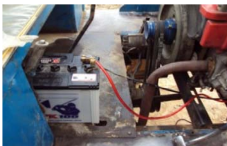
ภาพที่ 5 การต่อแบตเตอรี่เข้ากับชุดแยกก๊าซไฮโดรเจน
