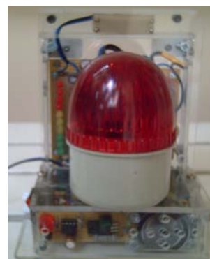
ภาพที่ 4 อุปกรณ์เตือนภัยกระแสไฟฟ้ารั่วที่สร้างขึ้นมา
