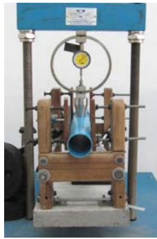
ข) การทดสอบแรงดัด
