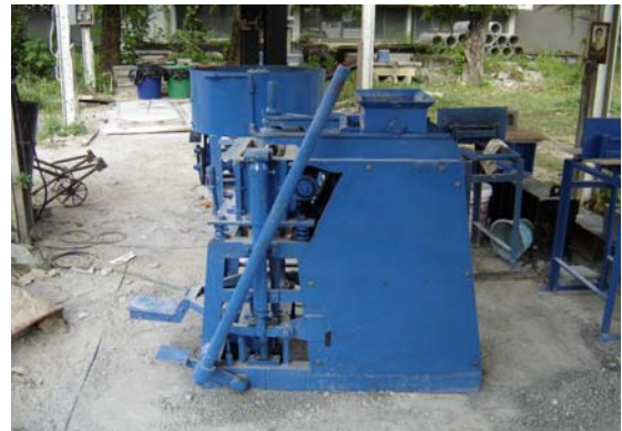
ภาพที่ 1 เครื่องอัดบล็อกแบบเท้าเหยียบ
