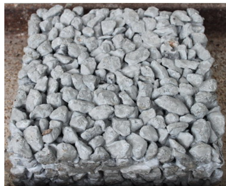
ภาพที่ 1 คอนกรีตพูนที่ใช้หินขนาด 3/4 นิ้ว
