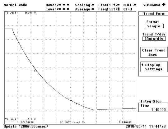
ภาพที่ 15 สัญญาณแรงดันไฟฟ้าซูเปอร์คาปาซิเตอร์คายพลังงานไฟฟ้าที่แรงดัน 14 โวลต์ กระแส 3 แอมป์
