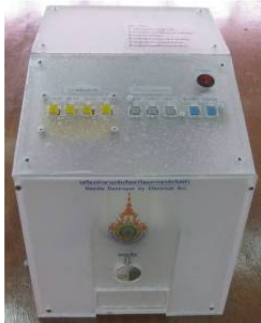
ภาพที่ 7 เครื่องทำลายเข็มนิโคตยาโดยใช้การอาร์กไฟฟ้า
