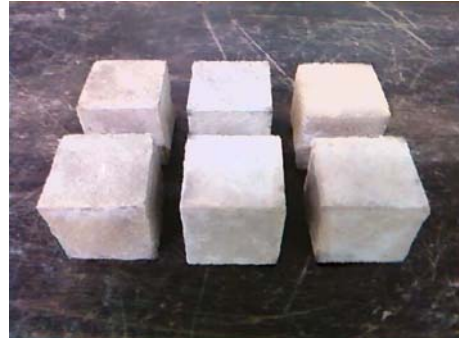
ภาพที่ 3 ตัวอย่างทดสอบมอร์ตาร์
