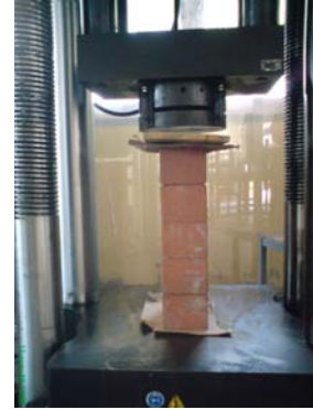
ภาพที่ 6 บล็อกประสานก่อ 5 ชั้นเพื่อทดสอบกำลังอัด
