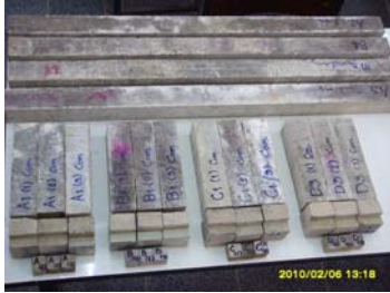
ภาพที่ 3 ตัวอย่างไม้เทียมที่เตรียมไว้สำหรับทดสอบ
