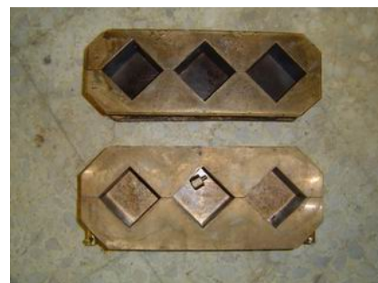
ภาพที่ 2 แบบหล่อทองเหลือง ขนาดมาตรฐาน ASTM C 109 / C 109 M-99 [4]
