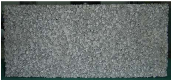
ภาพที่ 6 ลักษณะของคอนกรีตบล็อกพรุน ชุดทดสอบที่ 8
