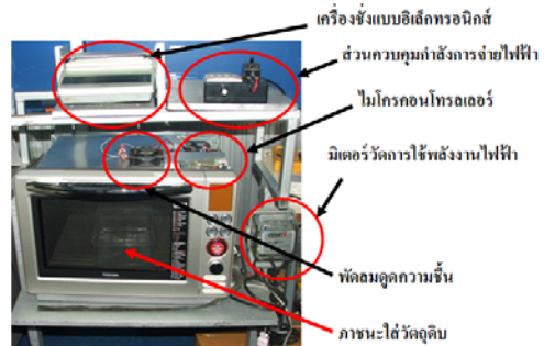
ภาพที่ 1 ควบคุมกำลังของการให้ความร้อนด้วยคลื่นไมโครเวฟสำหรับกระบวนการอบแห้งที่ควบคุมอุณหภูมิได้
