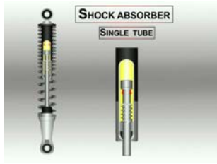
ภาพที่ 1 โช้คอัพแบบกระบอกชั้นเดียว
