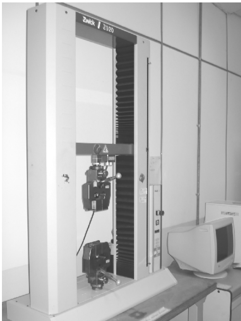
ภาพที่ 2 แสดงเครื่องทดสอบแรงดึงวัสดุ
