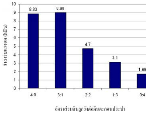
ภาพที่ 10 ความสัมพันธ์ระหว่างกำลังรับแรงอัดกับอัตราส่วนดินลูกรังต่อดินตะกอนประปา
