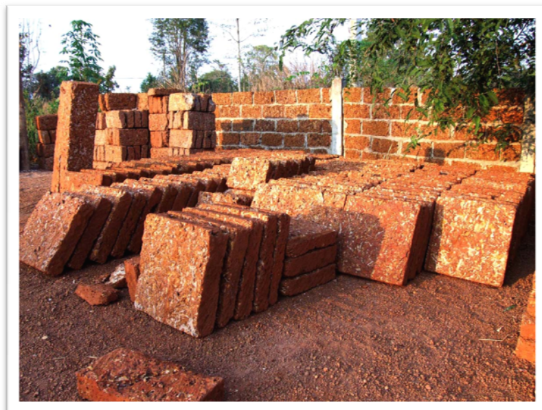
รูปที่ 4 ลักษณะศิลาแลงที่ผ่านการตัดเป็นก้อน เมื่อทิ้งไว้ในอากาศจะมีความแข็งเพิ่มขึ้น
