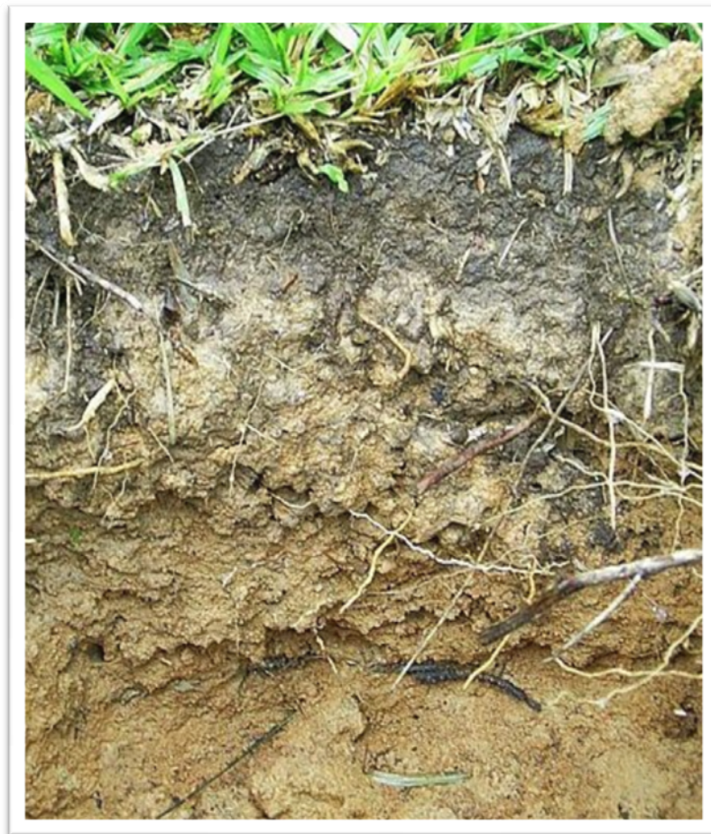
รูปที่ 7 ดินลูกรัง ชั้นลูกรัง ชั้นกรวด ชั้นเศษหิน
