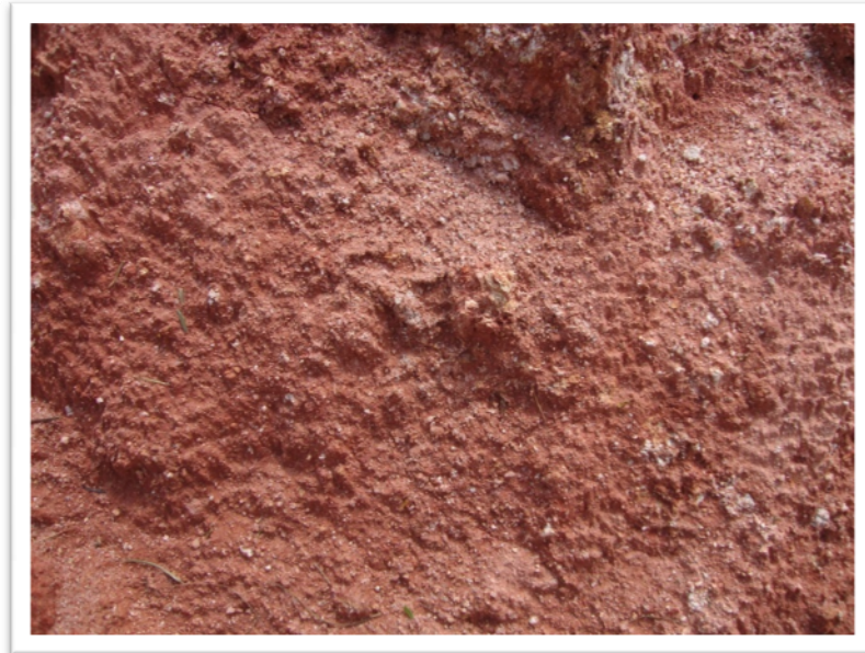
รูปที่ 3 ดินลูกรัง เป็นดินผสมกับลูกรังที่เกิดการสีกกร่อนตามธรรมชาติของศิลาแลง
