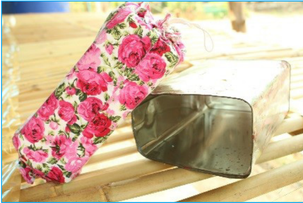
ภาพที่ 16 การใช้ปั่นน้ำมันขนาดเล็กเป็นแม่พิมพ์และตัวอย่างหมอนขิดยางพาราจากแม่พิมพ์ปั่นน้ำมัน
