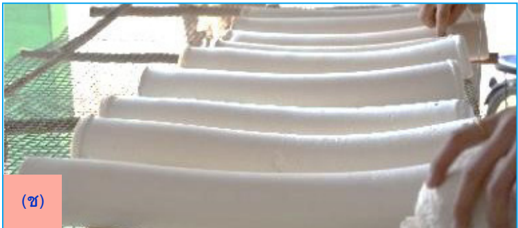
ภาพที่ 9 การถ่ายทอดความรู้สู่ วชพศ. (ก) บรรยายเบื้องต้นวิธีการผลิตยางพองน้ำ (ข) – (จ) ปฏิบัติการเตรียมน้ำยางข้นชนิดครีม และวิธีเตรียมยางพองน้ำ (ฉ) แนะนำวิธีการคงรูปร่างพองน้ำด้วยหม้อหนึ่งถังน้ำมันขนาด 200 ลิตรและ (ช) การฝั่งยางพองน้ำให้แห้ง
