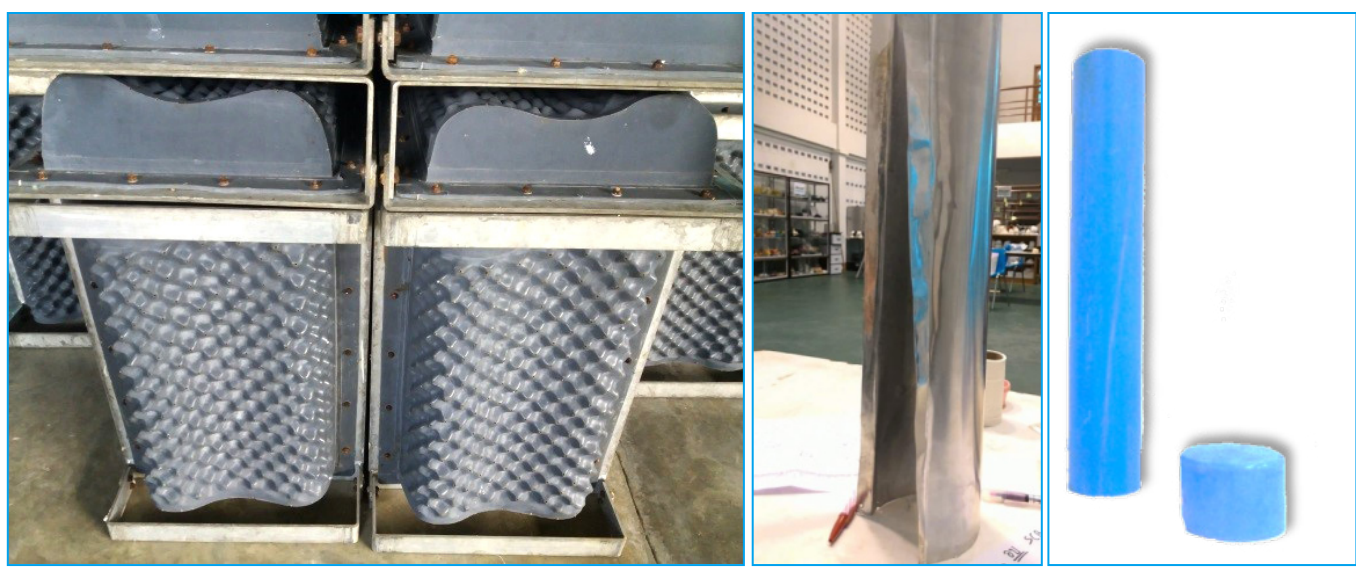
ภาพที่ 6 ลักษณะแม่พิมพ์ที่ใช้ขึ้นรูปผลิตภัณฑ์ยางพองน้ำ (ก) แม่พิมพ์พลาสติกโครงเหล็กที่ใช้ในอุตสาหกรรมผลิตหมอนยางพารา (ข) แม่พิมพ์แผ่นสังกะสี และ (ค) แม่พิมพ์ท่อพีวีซี
