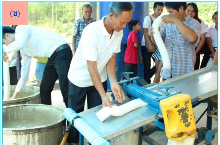
ภาพที่ 15 การล้างทำความสะอาดไส้หมอนยางพารา (ก) ด้วยแรงงานคน (ข) ด้วยเครื่องนวดยางแผ่นดิบ
