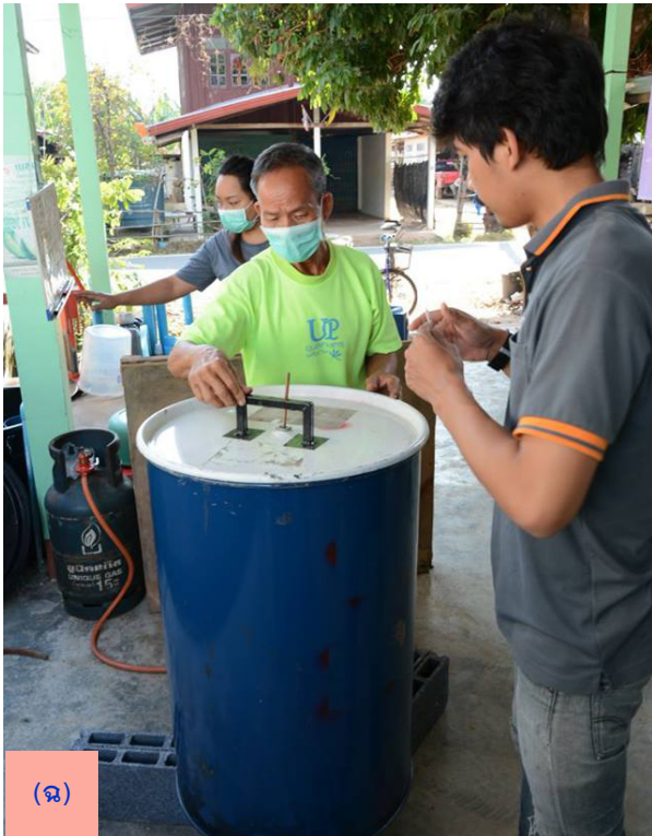
ภาพที่ 9 การถ่ายทอดความรู้สู่ วชพศ. (ก) บรรยายเบื้องต้นวิธีการผลิตยางพองน้ำ (ข) – (จ) ปฏิบัติการเตรียมน้ำยางข้นชนิดครีม และวิธีเตรียมยางพองน้ำ (ฉ) แนะนำวิธีการคงรูปร่างพองน้ำด้วยหม้อหนึ่งถังน้ำมันขนาด 200 ลิตรและ (ช) การฝั่งยางพองน้ำให้แห้ง
