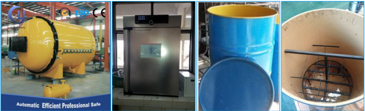
ภาพที่ 7 อุปกรณ์ที่ใช้ในการเตรียมยางพองน้ำสุกจากยางพารา (ก) หม้อนิ่งความดันไอน้ำ (ข) ตู้อบลมร้อน และ (ค), (ง) หม้อนิ่งจากถังน้ำมันขนาด 200 ลิตร
