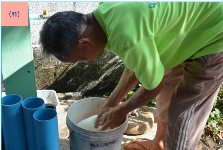
ภาพที่ 15 การล้างทำความสะอาดไส้หมอนยางพารา (ก) ด้วยแรงงานคน (ข) ด้วยเครื่องนวดยางแผ่นดิบ
